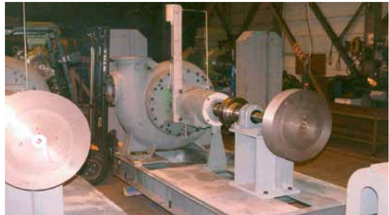
Bild 8.1.3-a: Die Keilriemenscheiben werden als Vollscheiben ausgeführt.
