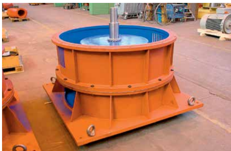
Bild 8.1.3-b: Vertikal angeordnete Schwungscheibe (Antrieb über Gelenkwelle, D = 790 \text{ mm} ).
